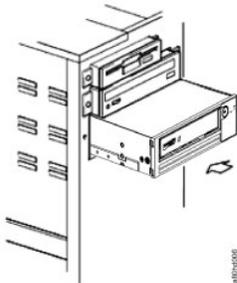
Sind bei dem System keine speziellen Teile für die Montage erforderlich, überprüfen Sie, ob die Löcher im Gehäuse mit den Löchern an der Seite des Bandlaufwerks ausgerichtet sind (siehe Abbildung 8).
