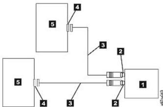
Anmerkung: Im Gegensatz zu SCSI können bei der SAS-Architektur nicht mehrere Bandlaufwerke an einen einzigen SAS-Hostadapter angeschlossen werden.
